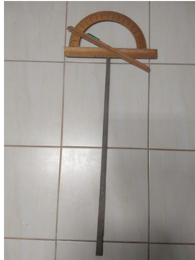
Figura 4: Aparelho de topografia a partir de materiais reaproveitados para a prática dos senos, cossenos e tangentes dos ângulos
